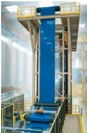
L' alluminio arriva dal laminatoio sotto forma di bobine (coil). La bobina viene posizionata all'inizio della linea di verniciatura, e viene poi srotolata a velocità costante, passando attraverso un pretrattamento, vari bagni di verniciatura e forni di vulcanizzazione, prima di essere riavvolta.
