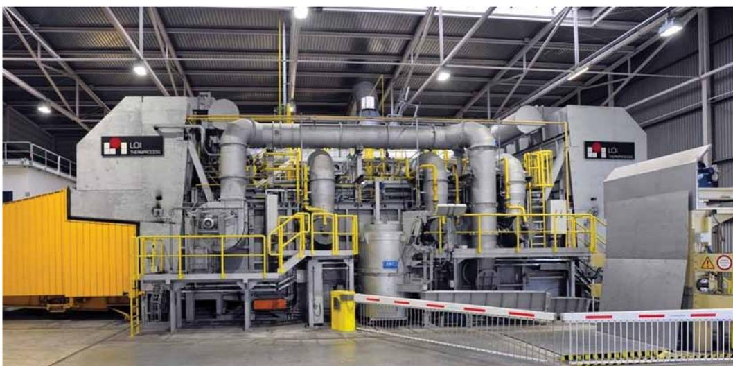
prima camera e le emissioni di gas vengono raccolte tramite efficienti apparecchiature di trattamento dei fumi. Il trattamento termico per la fusione dell'alluminio avviene invece soprattutto nella seconda camera.
